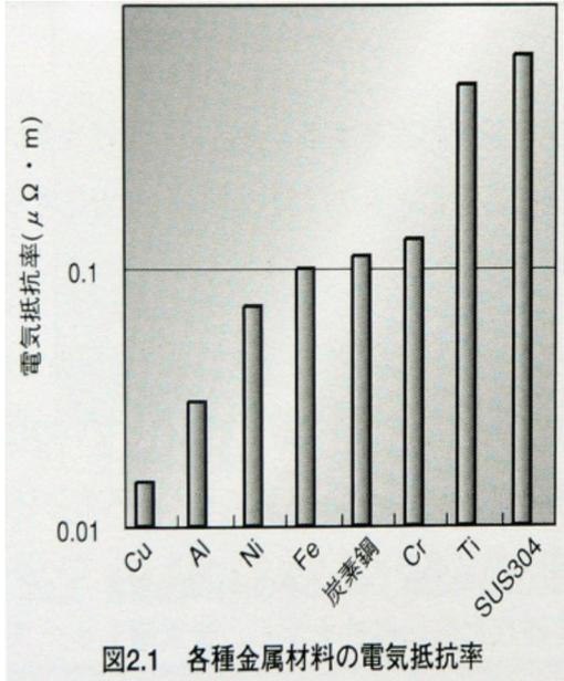
抗率は、純銅のほぼ100倍でステンレス鋼の主構成元素であるFe、Cr、Niのいずれに対しても一桁程度大きいのです。こうした特性によりステンレス鋼を電機・電子部品として使用することは基本的に難しいと言えます。さらにステンレス鋼表面には高抵抗性の不動態被膜や酸化膜が存在するの
